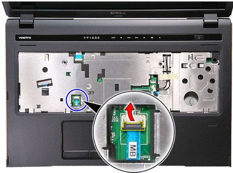
16. タッチパッドデータケーブルをシステム基板のコネクタから取り外します。
